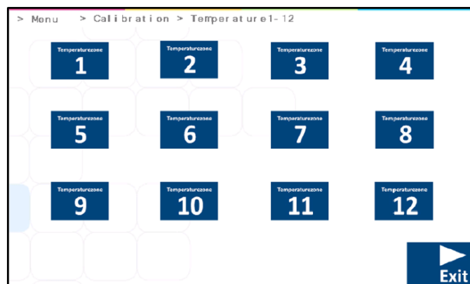
Obrázok 13.19 12 kalibračných zón v multiroom IVF inkubátore MIRI® TL6
