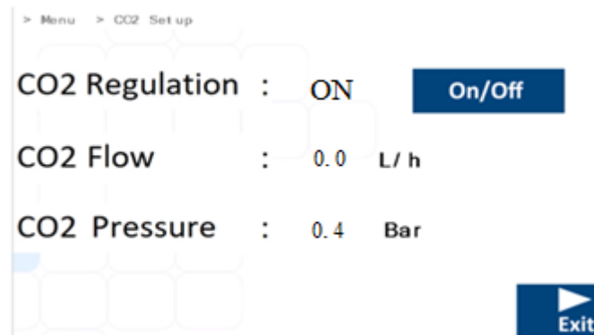
Obrázok 13.25 Zobrazenie podponuky Nastavenie CO 2 v multiroom IVF inkubátoroch MIRI® TL6 a MIRI® TL12
