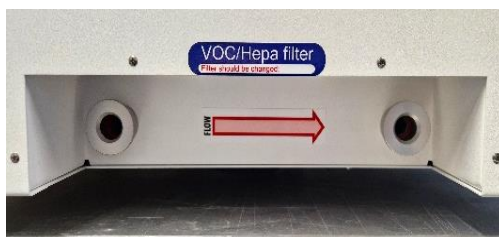
Obrázok 12.1 Smer prúdenia na viackomorových inkubátoroch MIRI® TL6 a MIRI® TL12 pre IVF.
