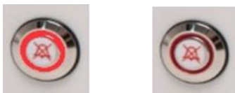
Obrázok 14.11 Tlačidlo alarmu, ktoré označuje stav alarmu
