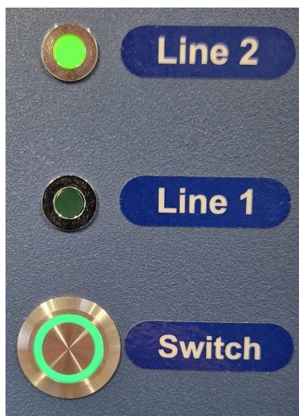
Obrázok 20.4 Prepínač zmeny linky multikomorového IVF inkubátora MIRI® TL12a aktívna linka 1
